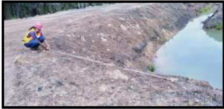
Gambar 4.6 Pengukuran Dimensi Settling Pond 2
